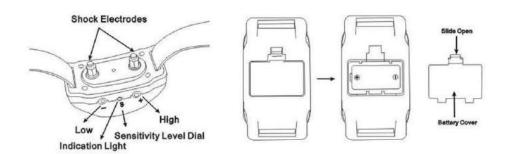
Ошейник можно регулировать для настройки датчика чувствительности определения лая, в зависимости от размера собаки и издаваемых её звуков. Настройка чувствительности производится с помощью двух кнопок.
